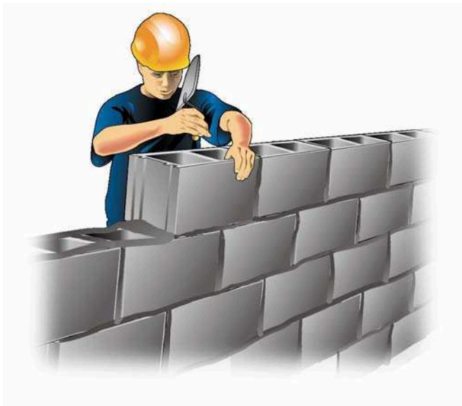
Posa a giunti verticali sfalsati
