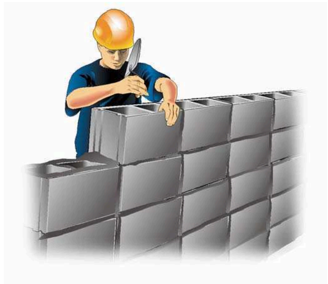
Posa a giunti verticali allineati (a sorella)
